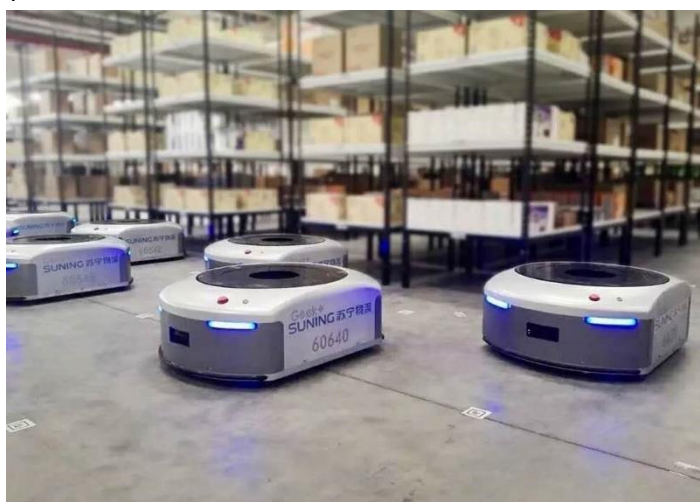
ภาพที่ 7.2 แสดงระบบหุ่นยนต์เคลื่อนย้ายสินค้าอัจฉริยะ GEEK+
